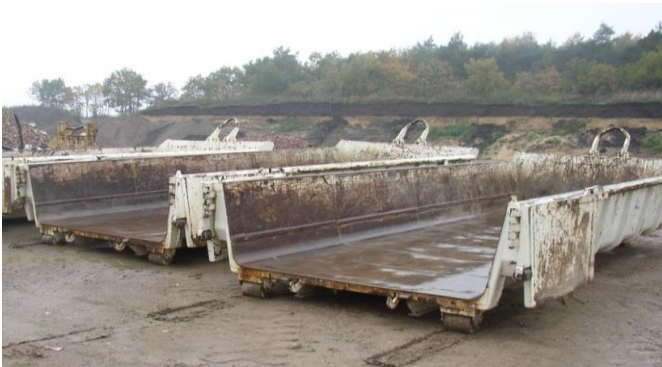
10 m 3 - Stapelbehälter (P 20) (P 21) (P 22) (P 32) (P ) (U 44) (U ) 6000 x 2340 x 750 mm
