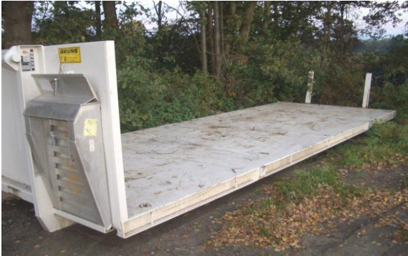
Plattform Typ AGPS 6500 Boden 5 (U 0010) 6500 x 2340 mm Oberfläche RAL 9010
